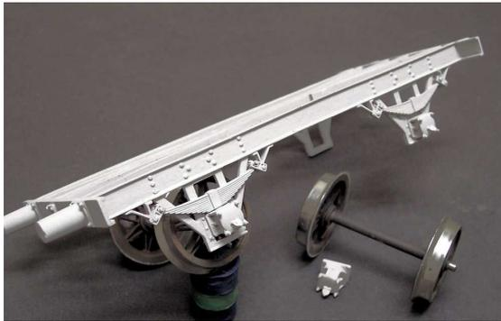
Der Ein- und Ausbau eines Radsatzes erfolgt durch Entfernen des Achslagers einer Seite.
